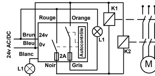
\*Toute surcharge ou court-circuit sur les lignes de sécurité provoque une ouverture de celles-ci de façon irrémédiable. Si vous estimez qu'il existe un risque, nous vous conseillons de protéger les lignes avec un fusible de 1.6A rapide.
